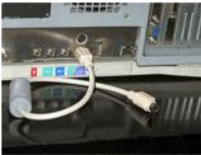
Schließen Sie den Sender an den PS/2-Port an
