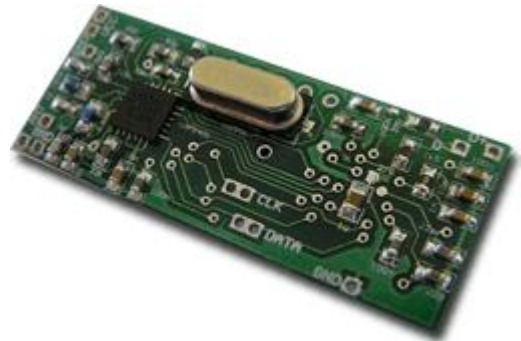
Zusammengebaute Leiterplatte - Unterseite mit Transceiver
