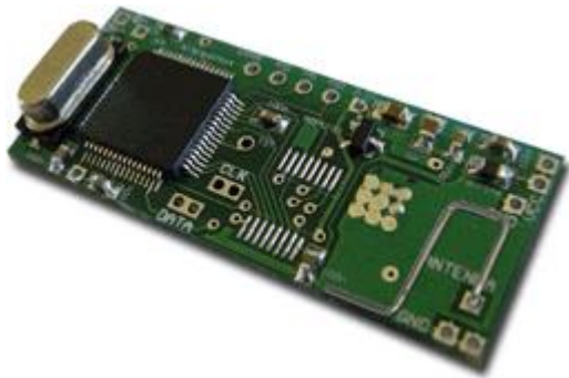
Zusammengebaute Leiterplatte - Oberseite mit Mikrocontroller
