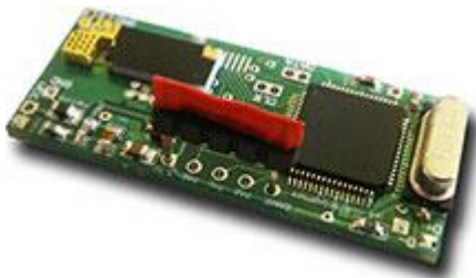
Löschen des Speichers (ERASE mit 3,3V kurzgeschlossen)
