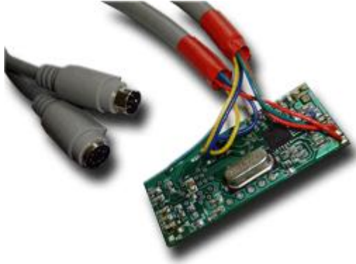
Émetteur avec câblage PS/2
