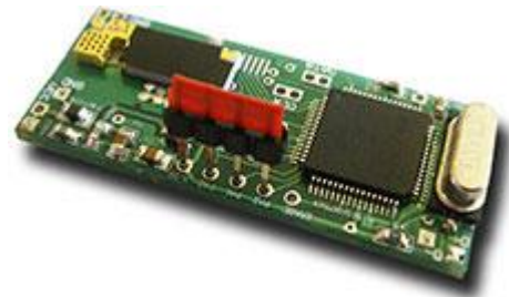
Activation du bootloader (PA0, PA1, PA2 et TST court-circuité avec 3.3V)
