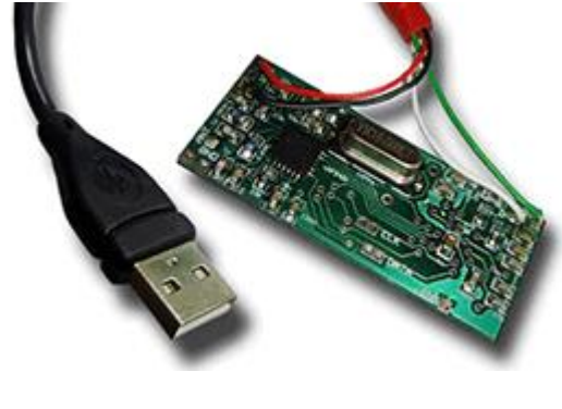
Ricevitore con il cablaggio USB
