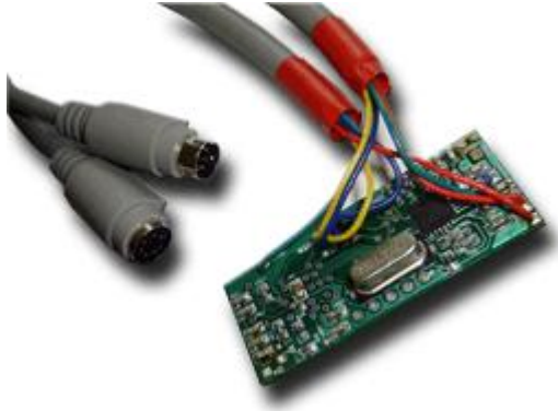
Trasmittitore con il cablaggio PS/2
