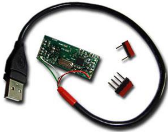
Il cavo USB e i jumper per il bootloader SAM-BA
