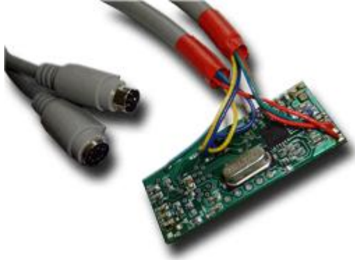
Nadajnik z okablowaniem PS/2
