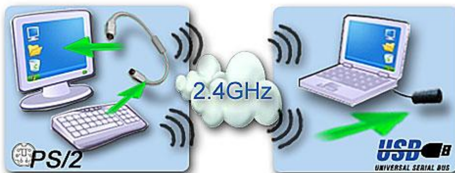
Bezprzewodowy Keylogger - schemat blokowy
