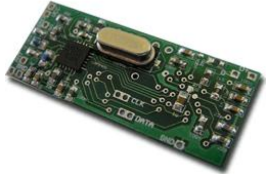
Zmontowana obwód drukowany - strona dolna z transceiverem
