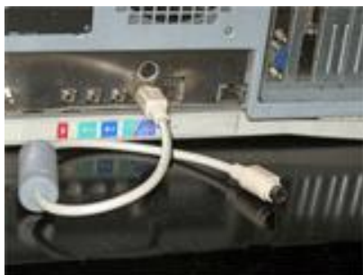
Podłącz nadajnik do portu PS/2
