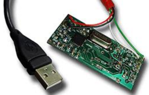
Odbiornik z okablowaniem USB
