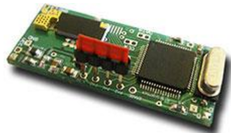
Activação do bootloader (PA0, PA1, PA2 e TST postos em curto-circuito com 3.3V)
