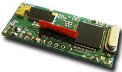
Apagamento da memória (ERASE posto em curto-circuito com 3.3V)
