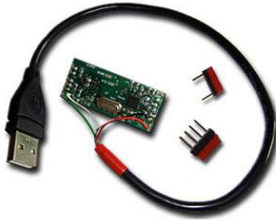
Кабель USB и перемычки для bootloader SAM-BA
