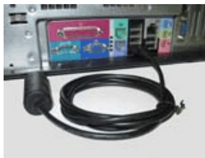
Подключить приёмник к свободному порту USB
