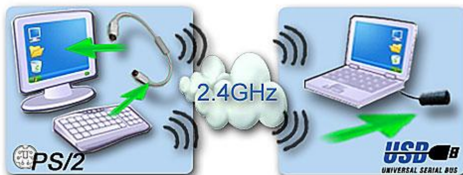
Беспроводной кейлоггер - блочная схема
