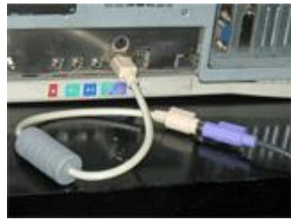
Подключить клавиатуру PS/2 к передатчику
